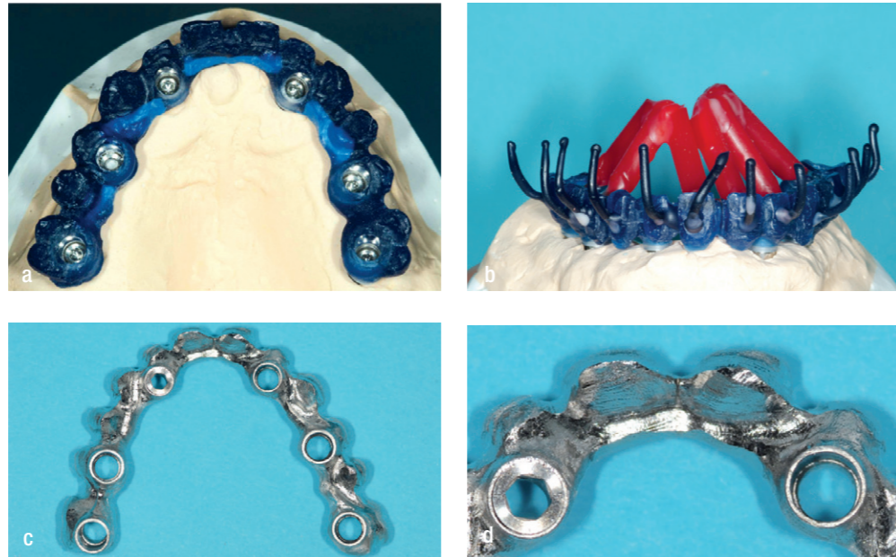
Figure 7a-d Modellazione in cera di una sovrastruttura che verrà realizzata in lega mediante fusione a cera persa (a). Impernatura del modellato per la messa in rivestimento (b). La fusione metallica (c); in una corona di ancoraggio è stato inserito un pilastro. Dettaglio del pilastro inserito nella corona (d).
